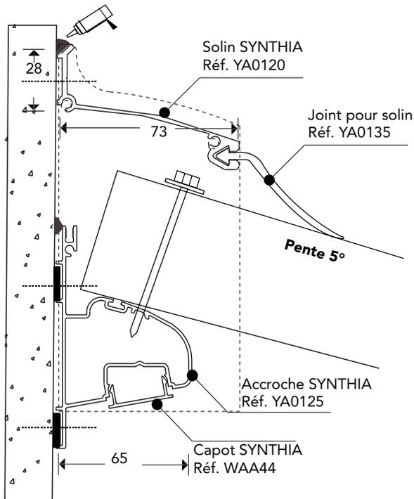
Vues de coupes du montage système en autoportant compatible SUN ISOL® 53, 70 et 75 mm
