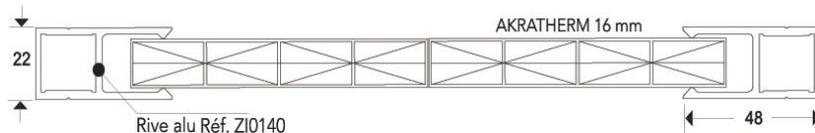
Le cadre est composé d'un profil aluminium tubulaire périphérique et d'une plaque en polycarbonate alvéolaire de 16 mm résistante aux UV.
