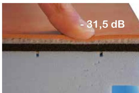
Les panneaux IMPACT CONTROL® permettent une réduction des bruits d'impact jusqu'à -31,5 dB par rapport à un panneau standard.
