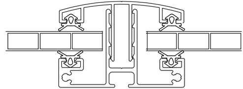
Avec la gamme de profils DECLIC, réalisez facilement et rapidement les couvertures légères pour pergolas aluminium.
